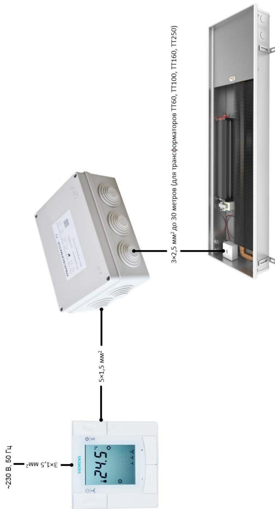
Схема D: Ручное/автоматическое трёхскоростное регулирование
